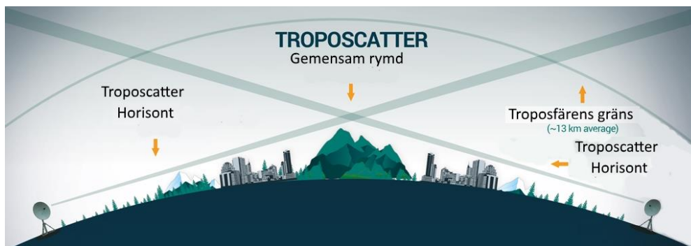
Principen för troposcatter-kommunikation.
